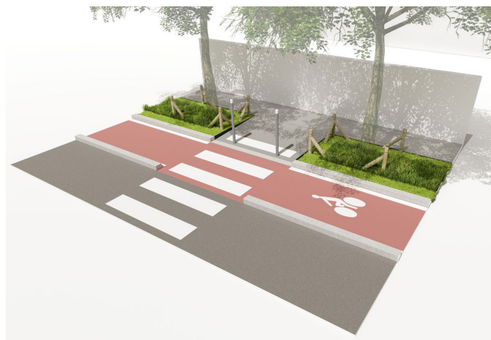
Traversées piétonnes (piste sur chaussée)
