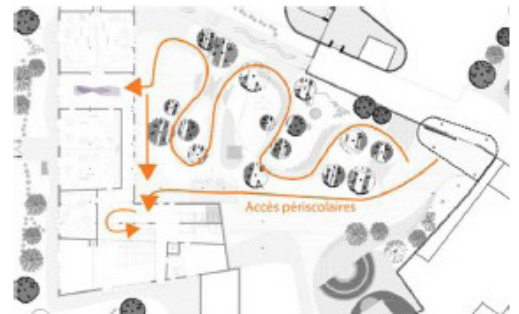
Flux dédié aux locaux périscolaires sans transiter par les autres locaux de l'établissement.
